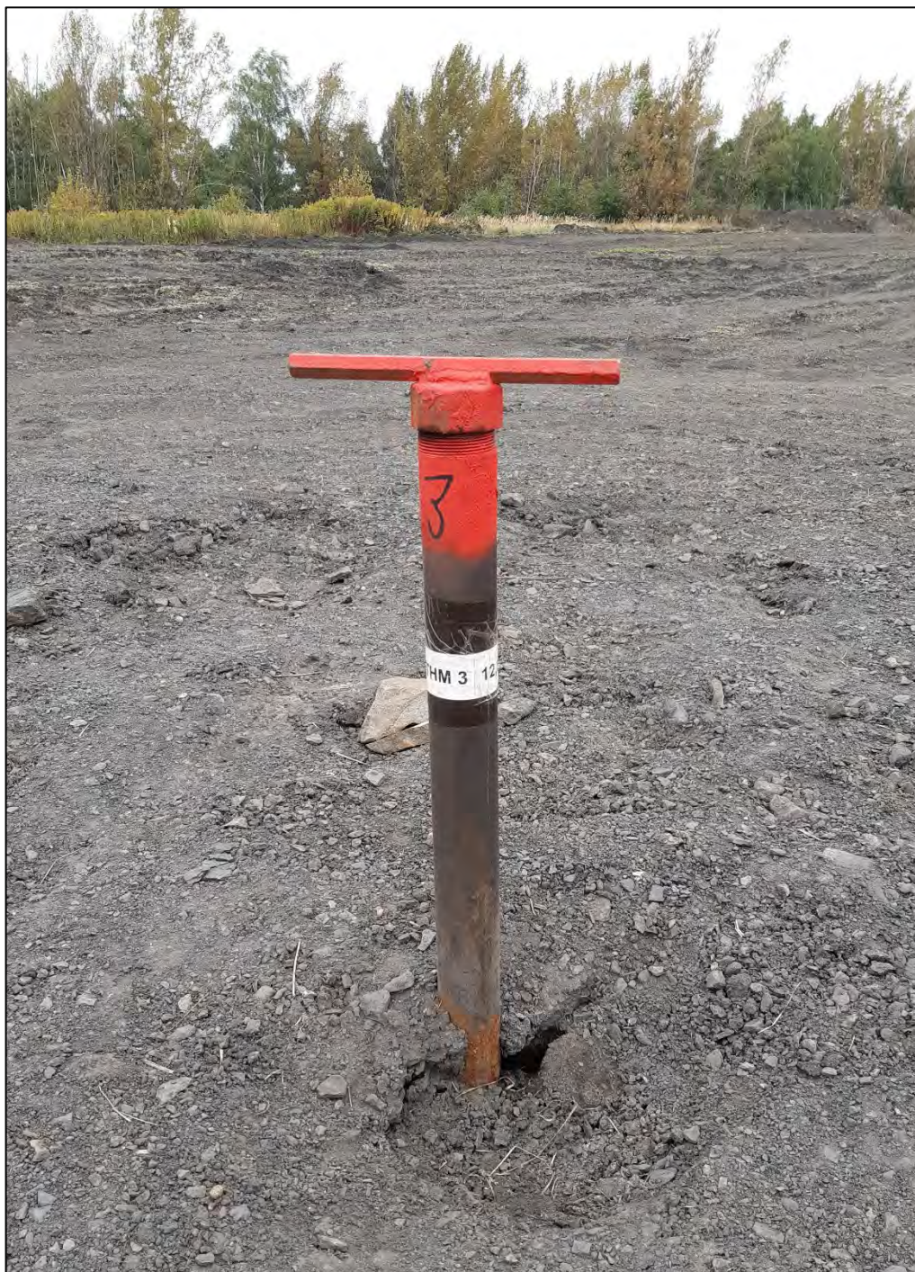
Obr. č. 8: Umístění termometrické sondy č. 3 na temeni střední části odvalu
